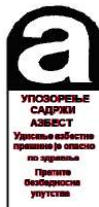
Слика 3.2: Обележавање производа који садрже азбест директним штампањем на производ
