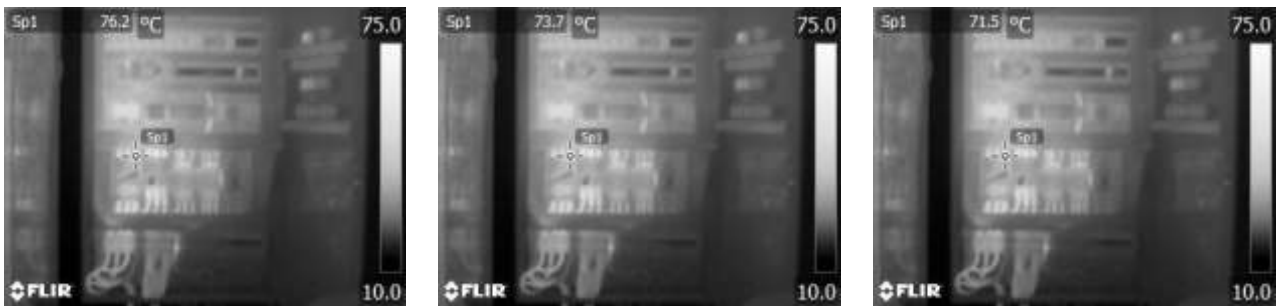
Слика 3 - Утицај коефицијента емисивности на мерење температуре: \varepsilon=0,9 лево, \varepsilon=0,95 средина, \varepsilon=1,0 десно
