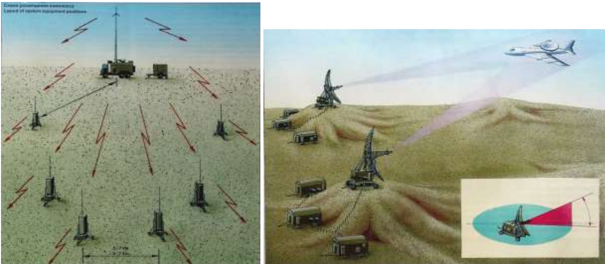
а) б) Слика 5 – Размештај система за ометање навигационих и радарских сигнала
