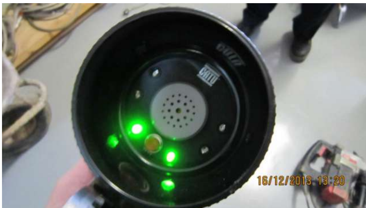
Слика 6. Провера исправности индикатора напона тест тастером
