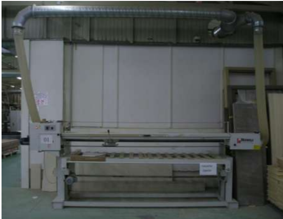
Слика 7 – Централни уређај за отпрашивање са прикључцима на тракастој брусилици
