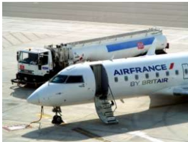
Слика 4. Процедра утакања горива у ваздухоплов
