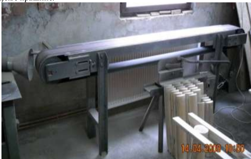
Слика 3 – Небезбедна тракаста брусилеца
