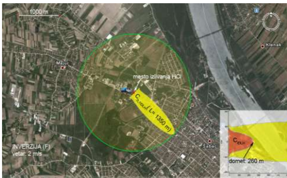
Слика 2. Зоне простирања опасних концентрација HCl, након 30 min од почетка дисперзије, у условима стабилне атмосфере и при брзини ветра од 2 m/s
