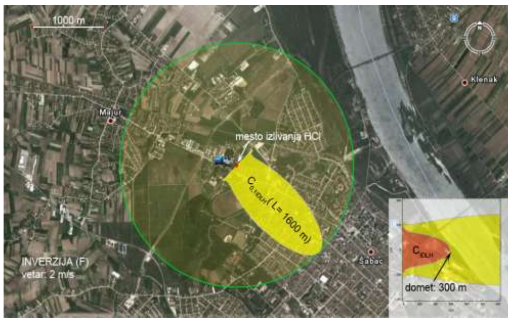
Слика 1. Зоне простирања опасних концентрација HCl, за почетне услове дисперзије (до 10 min од почетка изливања) у условима стабилне атмосфере и при брзини ветра од 2 m/s
