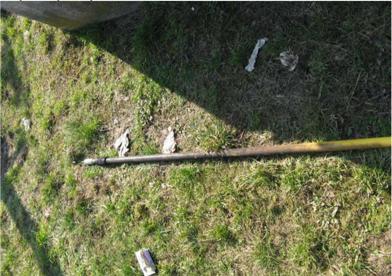
Слика 1. Изолациона мотка након контакта са електричним луком
