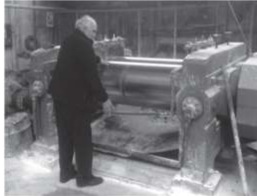
Слика 3 – Заштитна полуга у висини стомака
