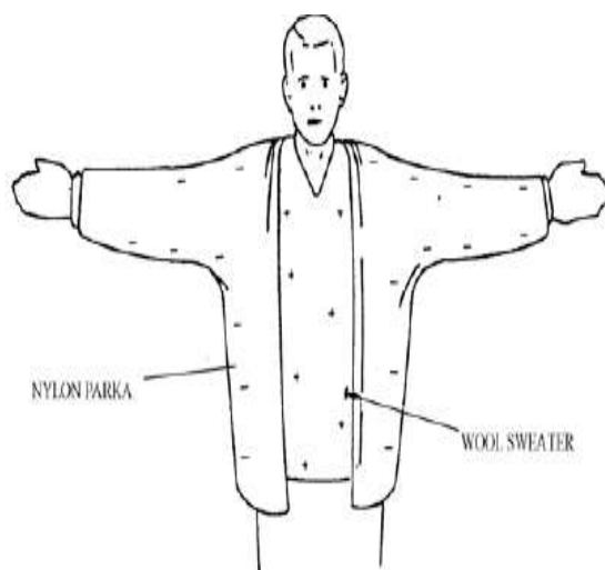
Слика 3. Генерисање статичког електрицитета путем трења
