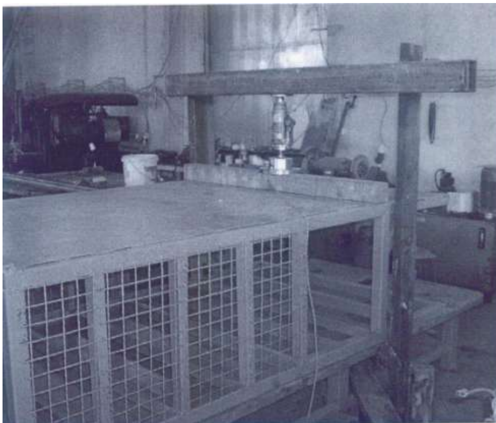
Слика 6-Испитивање пресека 7 заштитног кавеза
