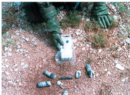
Slika 2 - Merenje radioaktivne kontaminacije uzoraka MOU na zemljištu
