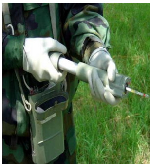
Slika 3 - Način detekcije otrovnih hemijskih supstanci (OHS)
