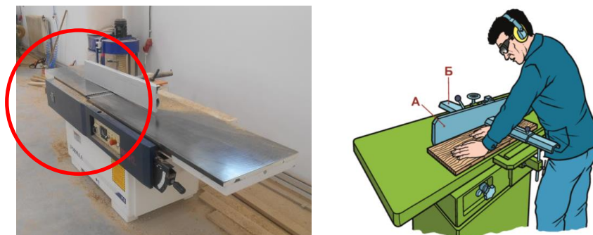
Slika 5 - Vodilica (levo - sopstveni izvor / desno – adaptirano prema Hand-fed surface planing machines)
