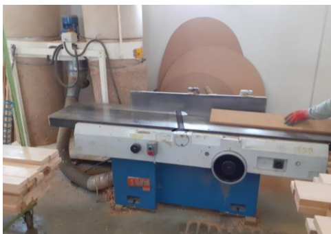
Slika 6 - Lokalna izduvna ventilacija kod ravnalice (levo - sopstveni izvor / desno – adaptirano prema Hand-fed surface planing machines )
